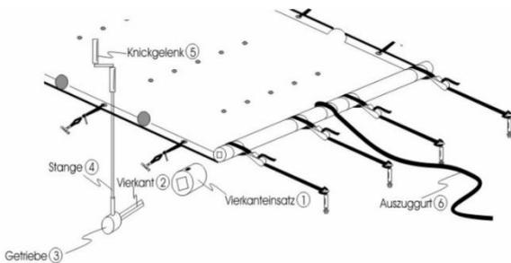
Abb. 07 – Kurbelstange für Vierkanteinsatz
